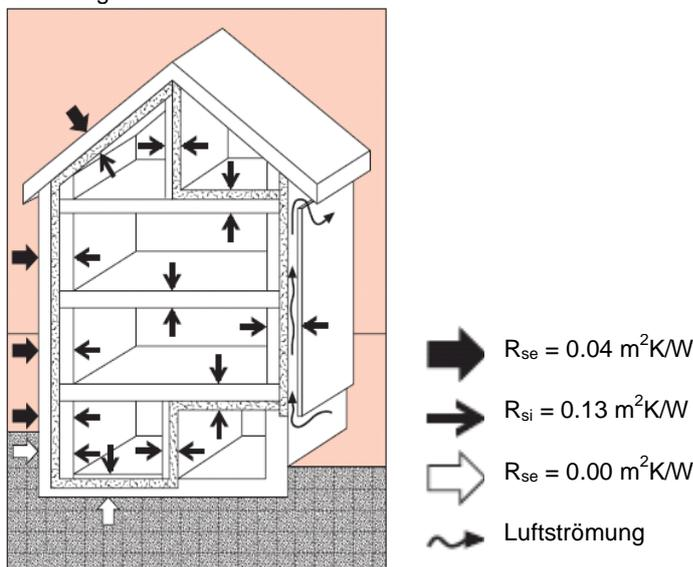
Die Bauherrschaft ist nicht glücklich mit den tatsächlichen Baukosten der Wärmedämmung. Mit dem Einsatz von expandiertem Polystyrol können die Baukosten reduziert werden. Welchen U-Wert erreichen Sie mit EPS 20 cm und wie viel % (auf eine Stelle nach dem Komma gerundet) weicht dieser Wert von demjenigen der oben genannten Berechnung (0.16 W/m<sup>2</sup>K) ab?
